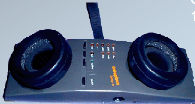
Acoustic Modem 1989 – Dataphon 300 - 2400 Bd FDX “Datenföhn”
