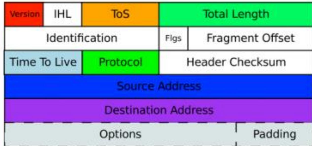
**An IPv4 Packet Header**
